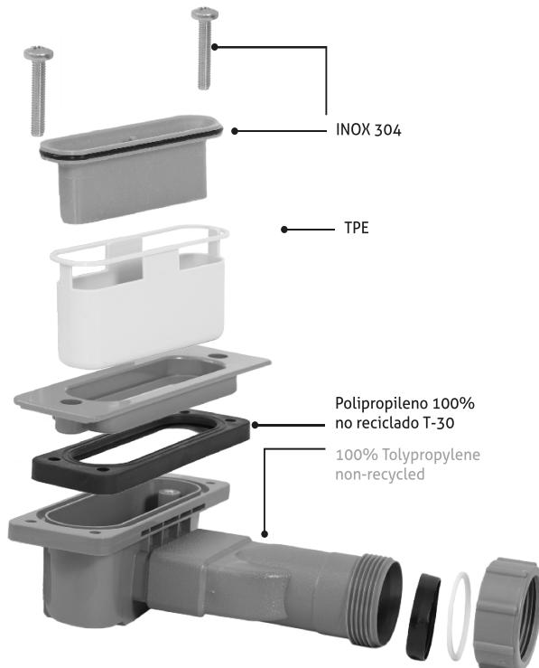
Fijar el cuerpo de la válvula por la parte inferior del plato de ducha mediante los tornillos.
