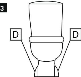
**Opgelet:** Maak geen gebruik van producten op basis van chloor of andere chemische producten aangezien deze schade kunnen aanrichten aan de verschillende onderdelen van het spoelreservoir alsook lekkage veroorzaken. Let er op dat de schroeven niet te hard zijn aangedraaid daar dit barsten kan veroorzaken in het spoelreservoir.
