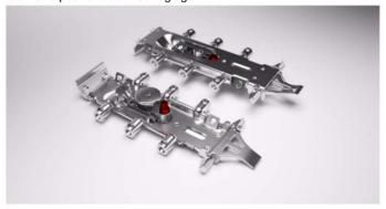
• LIBRA H2 est le support d'armoire universel avec 3 fiches + levier rotatif et peut être monté aussi bien à droite qu'à gauche. Cela nécessite quatre trous de Ø10 mm avec une profondeur de 13 mm sur les côtés.
