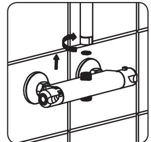
10. Boor de gaten. Let op dat er geen elektriciteitskabels of waterleidingen in de muur zitten.
