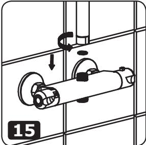
15. Schroef de douchestang, incl. de dichting, op de thermostatische kraan.
