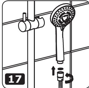
17. Draai de handdouche, incl. dichting met filter, op de doucheslang.
