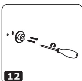
12. Schroef het bevestigingsstuk vast op de muur.
