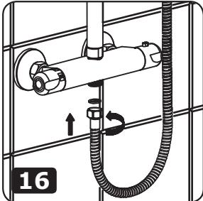
16. Sluit vervolgens de doucheslang, incl. de dichting, aan op de thermostatische kraan.
