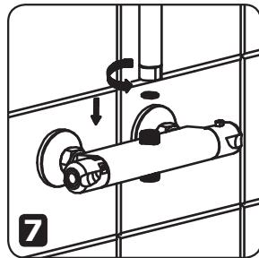
7. Schroef de douchestang, incl. de dichting, op de thermostatische kraan om te bepalen hoe hoog het douchesysteem zal hangen.
