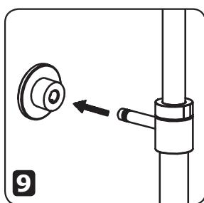
9. Gebruik de inbussleutel om de douchestang los te maken van het bevestigingsstuk. Schroef de douchestang, incl. de dichting, los van de thermostatische kraan.
