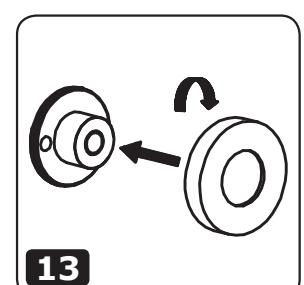
13. Schroef de rozet op het bevestigingsstuk.
