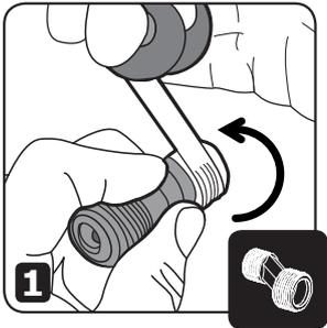
1. Omwindt de S-koppelingen met teflon vooraleer u deze aansluit op de waterleiding.
