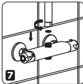
7. Schroef de douchestang, incl. de dichting, op de thermostatische kraan om te bepalen hoe hoog het douchesysteem zal hangen. *Vissez la barre de douche, joint inclus, sur le robinet thermostatique pour déterminer le hauteur du système de douche.*
