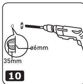
10. Boor de gaten. Let op dat er geen elektriciteitskabels of waterleidingen in de muur zitten. *Percez les trous. Notez qu'il n'y a pas de fils électriques ou des tuyaux d'eau cachés dans le mur.*
