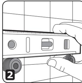
2. Zorg ervoor dat de 2 koppelingen waterpas staan en dat de afstand tussen de twee S-koppelingen 15 cm bedraagt. *Regardez que les 2 raccords sont en niveaux et qu'il y a 15 cm entre-axe des deux raccords S.*
