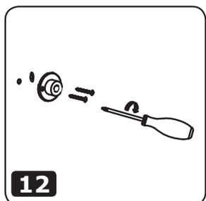
12. Schroef het bevestigingsstuk vast op de muur. *Vissez la pièce de fixation au mur.*
