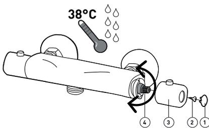
Indien de temperatuur van het water niet klopt met wat er op de handgreep staat, kan u dit bijstellen als volgt: maak het kapje (1) en de schroef (2) los, trek de greep (3) eraf en draai dan aan de spindel (4) tot het water de juiste temperatuur heeft (38 °C). Plaats dan de greep terug op de kraan in dezelfde positie als u ze er af nam.
