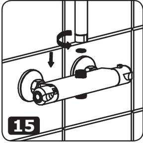
15. Schroef de douchestang, incl. de dichting, op de thermostatische kraan. *Vissez la barre de douche, joint inclus, sur le robinet thermostatique.*
