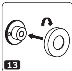
13. Schroef de rozet op het bevestigingsstuk. *Vissez la plaque de couverture sur la pièce de fixation.*
