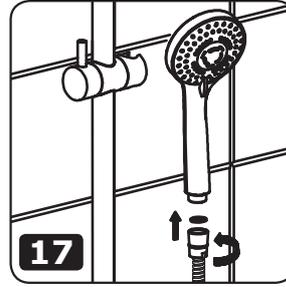
17. Draai de handdouche, incl. dichting met filter, op de doucheslang. *Attachez la douche à main, joint avec filtre inclus, sur le flexible.*
