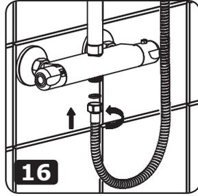
16. Sluit vervolgens de doucheslang, incl. de dichting, aan op de thermostatische kraan. *Raccordez ensuite le flexible de douche, joint inclus, sur le robinet thermostatique.*
