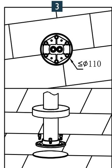
3. Werk de vloerafdichting af met siliconenkit. Let op: voordat u de vloer afkit; draai de hoofdkraan open en controleer de watertoevoer. Monteer de badmengkraan onder de juiste hoek op de vloer.
