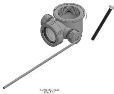
**Crépine** A combiner avec une crépine avec tige et la crépine free-flow Van Marcke (130095 VMP PLUG FREE FLOW 5/4) et crépine push-open (130096 VMP PLUG UP&DOWN 5/4)
