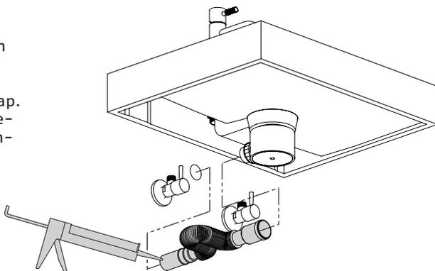
Montieren Sie den flexiblen Schlauch an den Siphon. Dann setzen Sie das Ende des flexiblen Schlauchs in den Kanalanschluss und Kleben Sie beide Teile.
