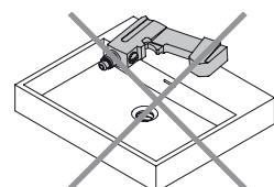
Pendant l'installation on doit empêcher endommager la surface du produit dû à placer des objets durs sur le produit.
