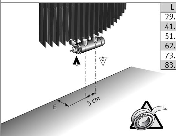
**6b** Aansluiting naar de vloer - Raccordement vers le sol
