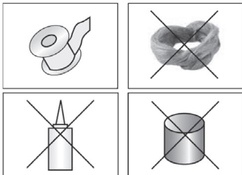
De schroefdraad van de moeren mag u enkel met teflon dichten.
