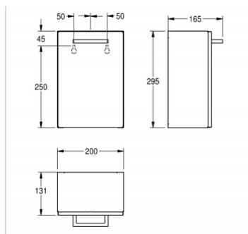
Poubelle pour serviettes hygiéniques et petits déchets pour montage mural, acier au chrome-nickel, finition satinée, épaisseur du matériau 0,8 mm, face avant repliée sur les côtés, capacité d'environ 3,7 litres, réservoir intérieur en plastique amovible, vis en acier inoxydable et chevilles incluses.
