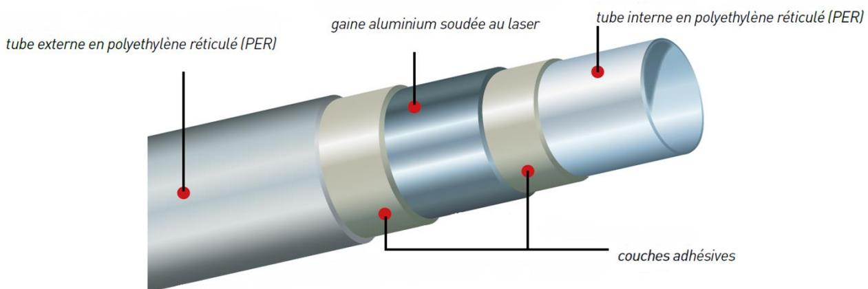
Le tube se compose d'un tuyau extrudé en PE-Rb (réticulation par "silanes"). Sur ce tuyau on colle une couche en aluminium fermée dans le sens de la longueur par une soudure bout à bout au laser. Sur cet ensemble est extrudé après encollage un tuyau en PE-Rb.
