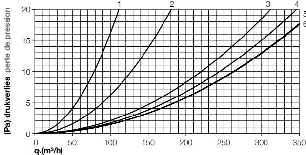
Drukverlies horizontaal plenum van het aantal aangesloten luchtkanalen
