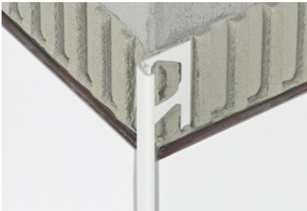
Schlüter®-JOLLY-P (farbiges PVC) ist aus durchgefärbtem Hart-PVC gefertigt und unempfindlich gegen Verbiegen oder Verkratzen. Das Material ist UV-stabilisiert, jedoch im Außenbereich nicht dauerhaft farbstabil. Nicht geeignet für Ecken- oder Belagsabschlüsse mit starker mechanischer Belastung, z.B. an Stufenkanten oder Bodenabschlüssen.
