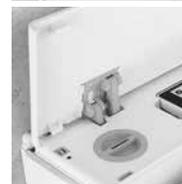
Извлеките использованный фильтр запаха, потянув его за держатель вверх; установите новый фильтр запаха. Снова закройте крышку, обозначенную символом «Вытяжка запаха», а затем – сервисную крышку.
