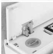
Retirez le filtre anti-odeurs usagé en tirant sa poignée verticalement vers le haut et insérez un nouveau filtre anti-odeurs. Refermez le couvercle, puis le clapet de service.
