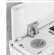
Trek het oude geurfilter verticaal aan de steel naar boven en plaats een nieuw geurfilter. Sluit daarna het deksel en de serviceklep weer.
