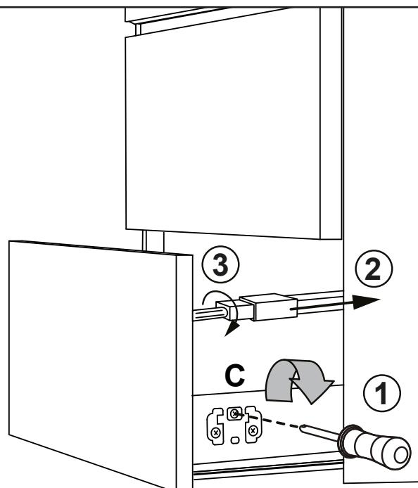
(NL) Voor lades breder dan 90cm: draai de twee schroeven van de frontstabilisering los om het laedefront te kunnen verwijderen. Draai de kruissleuf "C" aan weerszijden van de lade rechtsom om het frontpaneel te ontkoppelen. Bij hoge lades dient eerst de zijrail losgekoppeld te worden. (2) Trek het manchet naar achteren en (3) draai de kunststof kap los.
