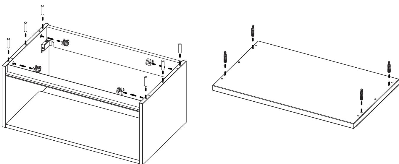
(NL) Plaats de deuvels en excenterbussen in de onderbouwkast en schroef de excenterpennen in het bovenblad.
