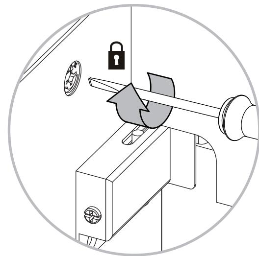
(NL) Plaats het bovenpaneel op de onderbouwkast draai de excenterbussen een halve slag rechtsom om het paneel te borgen.
