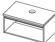
(NL) Zet van tevoren de kommen op het meubel en bepaal waar u de wasbak(ken) in de breedte wilt positioneren. Boor/zaag een uitsparing groot genoeg voor de afvoer van de opzetkommen. Bij gebruik van een opzetkraan dient een Ø35 mm gat geboord te worden ten minste 60mm van de achterkant van het meubel! De aangegeven maten voor de uitsparingen voor de waskommen zijn adviesmaten.
